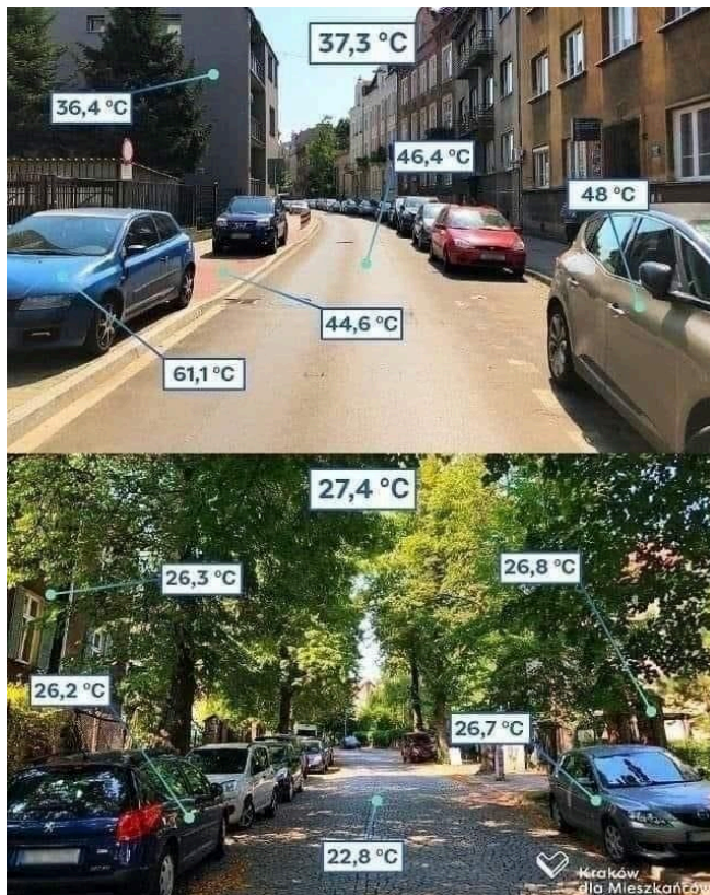
Figure 10 : Températures dans une rue ombragée comparées à une rue sans végétation
