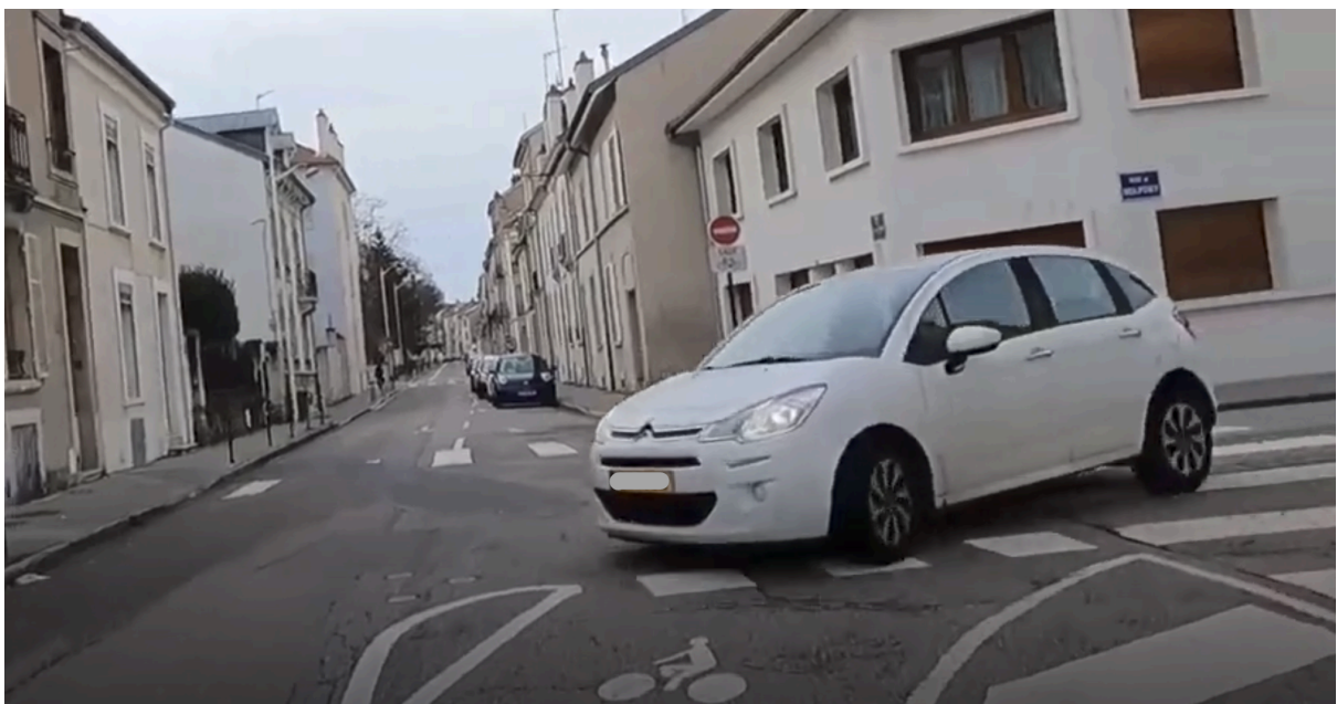
Figure 8 : Exemple de fin de DSC matérialisé uniquement avec de la peinture permettant aux automobilistes de couper la trajectoire des cyclistes et mettant ces derniers en danger.
